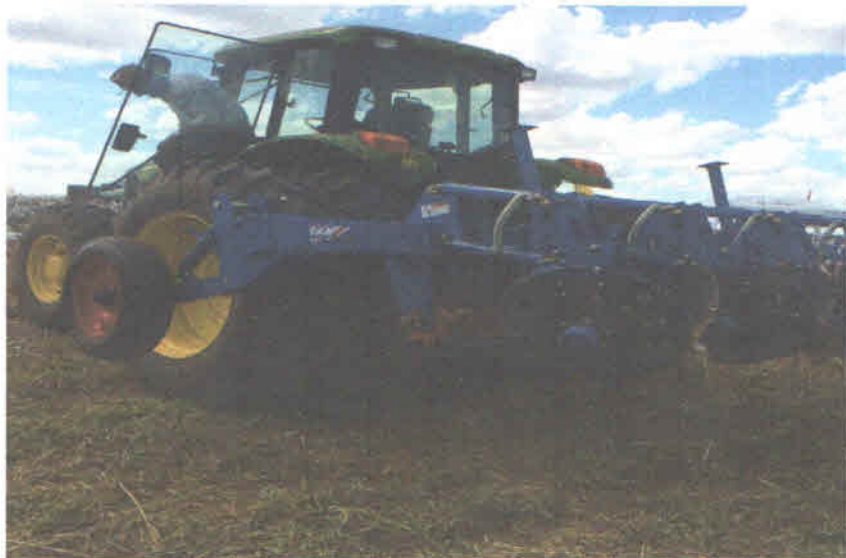
Figura 6 – Destruidor mecânico de soqueiras, para uso em plantio direto.
